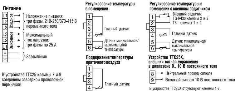
В устройстве TTC25 клеммы 7 и 9 соединены заводской проволочной перемычкой.
